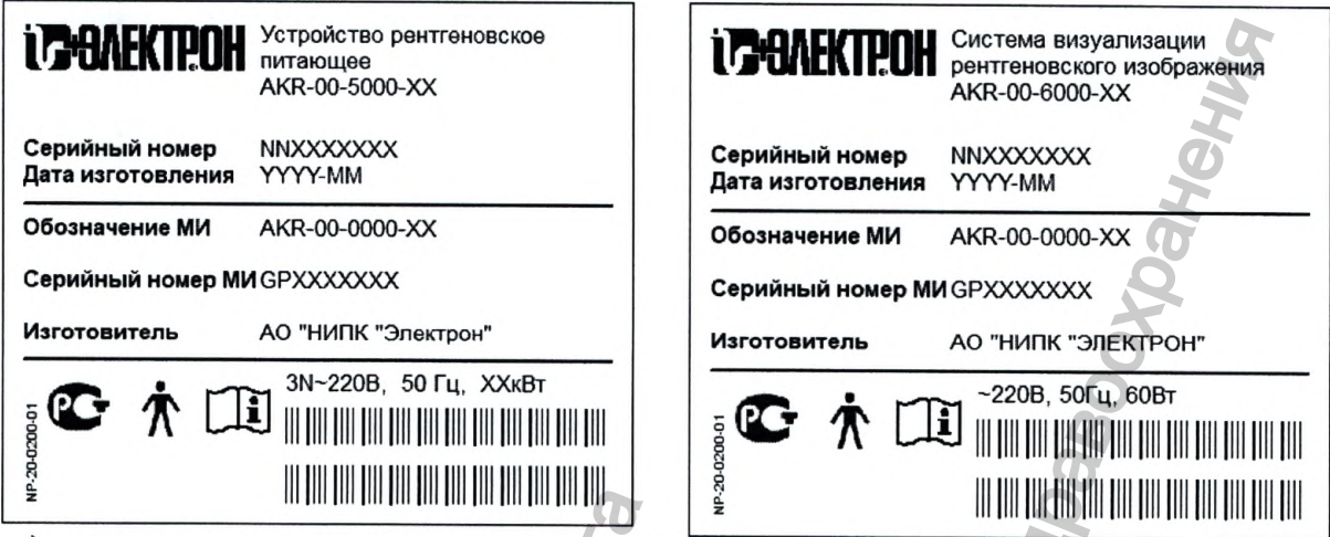
в) – рентгеновское питающее устройство г) – система визуализации Рисунок 2.23 – Примеры маркировочных табличек составных частей комплекса
