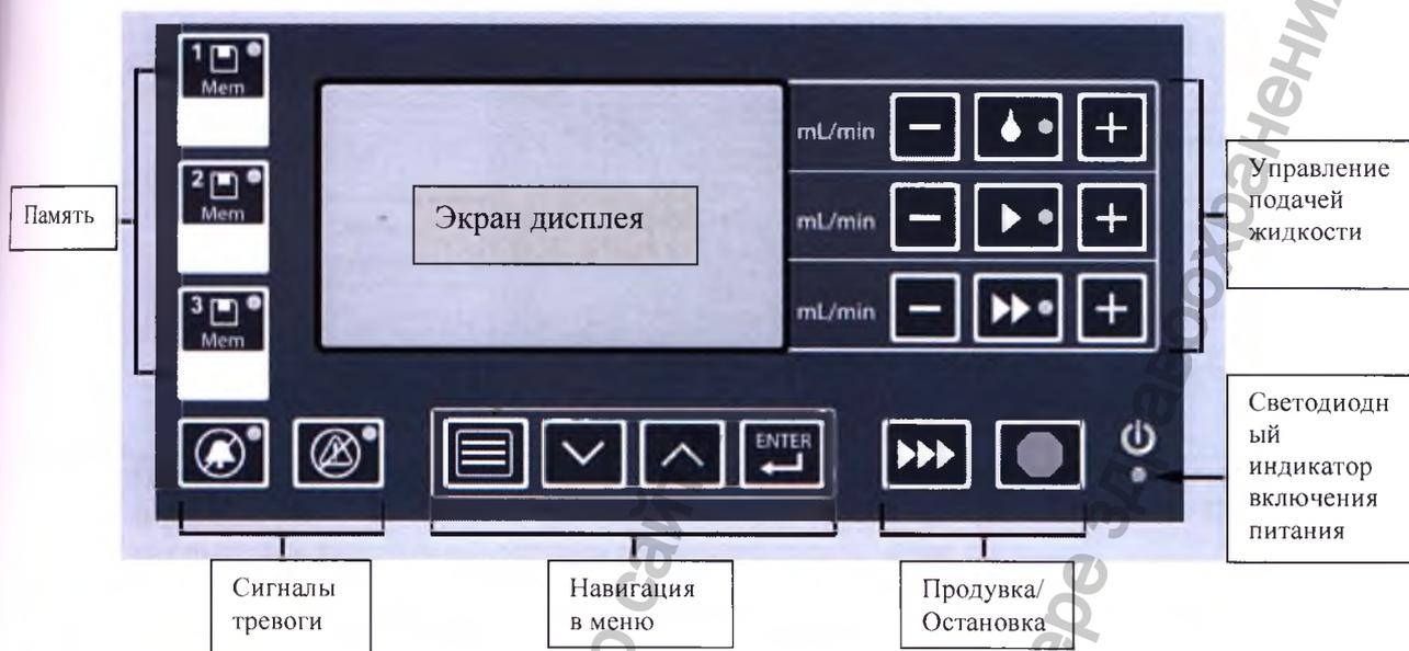
Рисунок 3. Кнопки управления на передней панели устройства MetriQ Pump (насоса)
