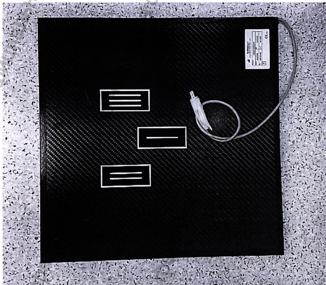
Ионизационная камера (может комплектоваться управляющим кабелем) 10358400 Dosemat, производства Gilardoni, Италия
