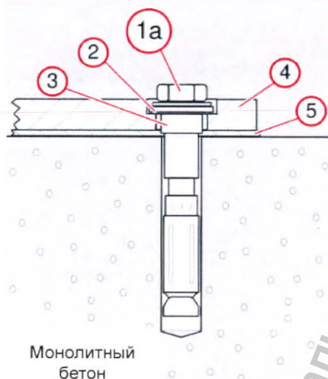
Рис. 24: Стол, установка усиленных распорных болтов
