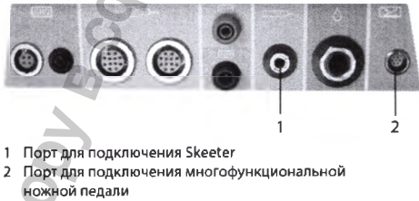
Рис. 10-2. Порт для подключения Skeeter к IPC
