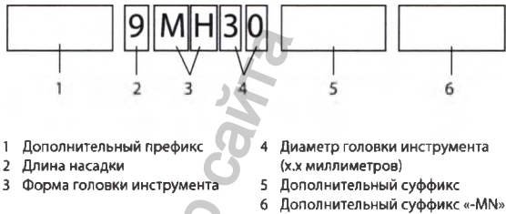
Рис. 9-1. Схема составления номенклатуры инструментов для препарирования
