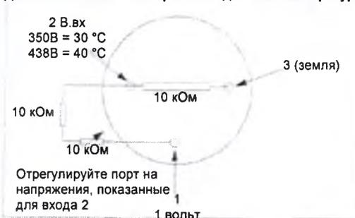
8. Включите монитор и отрегулируйте потенциометр 10 кОм, чтобы ЦММ показывал 0,350 В постоянного тока. На сенсорном экране должно отображаться значение температуры  $30,0 \pm 0,3$  °С.
