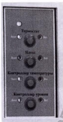
Включение/отключение блоков и устройств по отдельности
