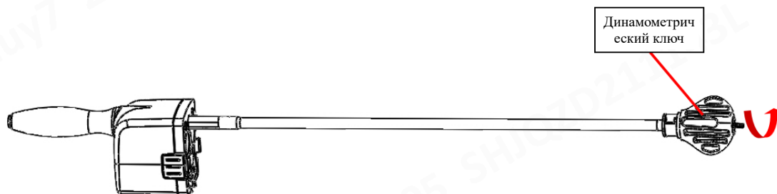
Рис. 2.19. Схематическое изображение работы динамометрического ключа
