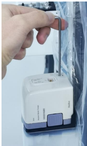
Рис. 2.3 Схема: инструмент аварийного выпуска
