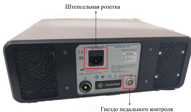
Рисунок 2.14. Задняя панель хоста ультразвуковых ножниц
