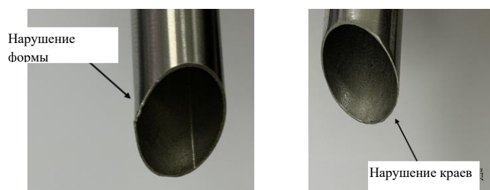
Рис. 2.11 Схема осмотра канюли троакара
