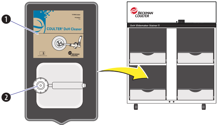
Рисунок 1.31 Расположение контейнера с очистителем и контейнера с отходами окрашивания в левом нижнем ящике напольной стойки
