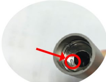
④ Очистка ватной палочкой, смоченной спиртом. ⑤ Очистка ватной палочкой, смоченной спиртом. ⑥ Очистка ватной палочкой, смоченной спиртом.
