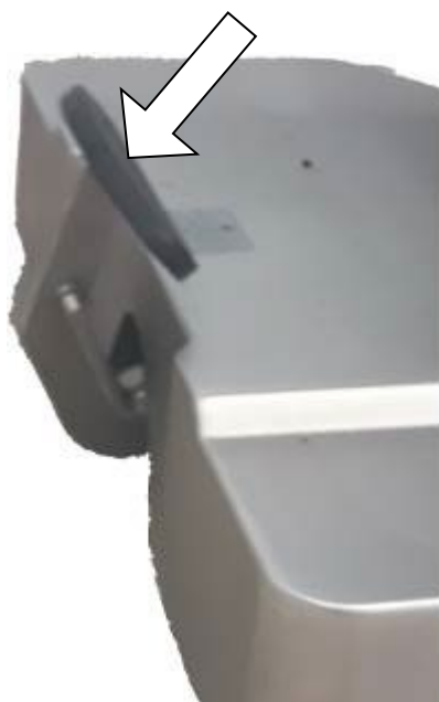
а – перевод стола в стационарное положение
