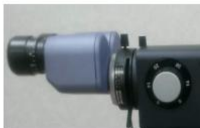
Рисунок 45: Окончательная сборка защитного фильтра для микроскопа на щелевой лампе
