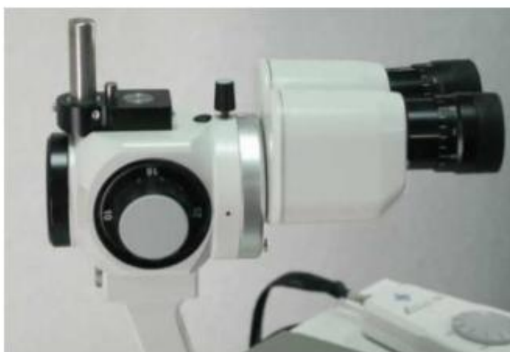
Рисунок 42: Установка тонометрического крепления навесного блока подачи излучения TruSpot к щелевой лампе
