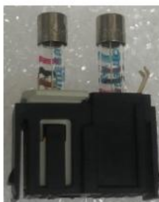
Рисунок 26: Извлечение блока установки напряжения
