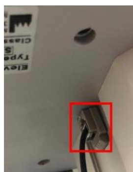
Рисунок 21: Прокладка кабеля из полости консоли на поверхность стола
