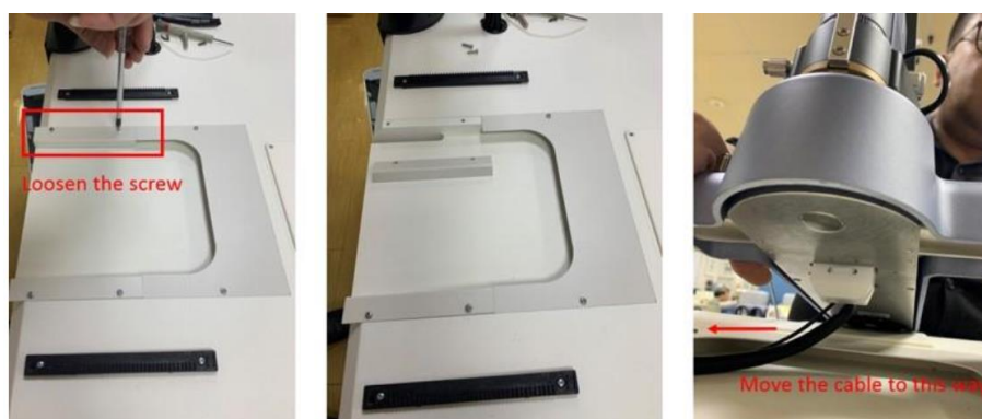
Рисунок 22: Прокладка кабеля и оптоволокну от щелевой лампы
