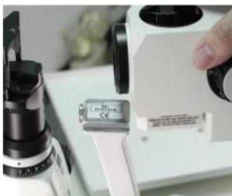
Рисунок 28: Установка увеличителя SD на монтажную пластину
