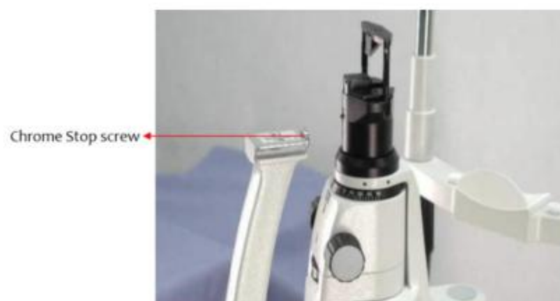
Рисунок 27: Ослабление хромированного стопорного винта на корпусе верхнего рычага
