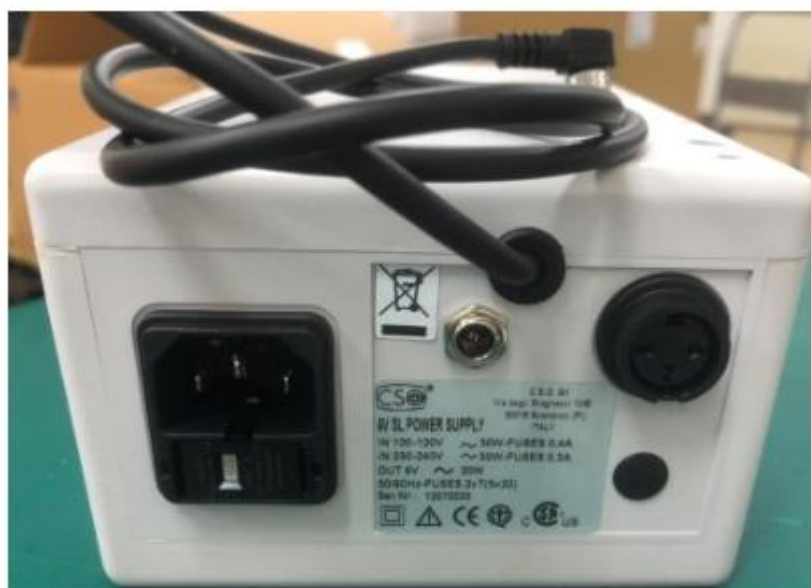
Рисунок 23: Номинальное напряжение блока питания
