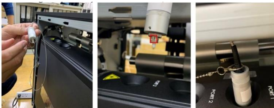
Рисунок 36: Подключение комплекта оптоволокон к Порту 1 консоли лазера
