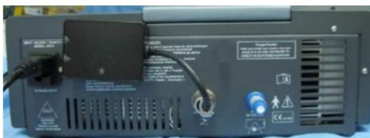
Рисунок 20: Подключения на задней панели блока управления
