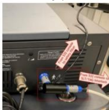
Рисунок 46: Окончательная сборка навесного блока подачи излучения TruSpot на щелевой лампе
