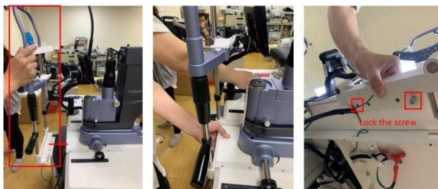
Рисунок 24: Крепление опоры для подбородка к столешнице
