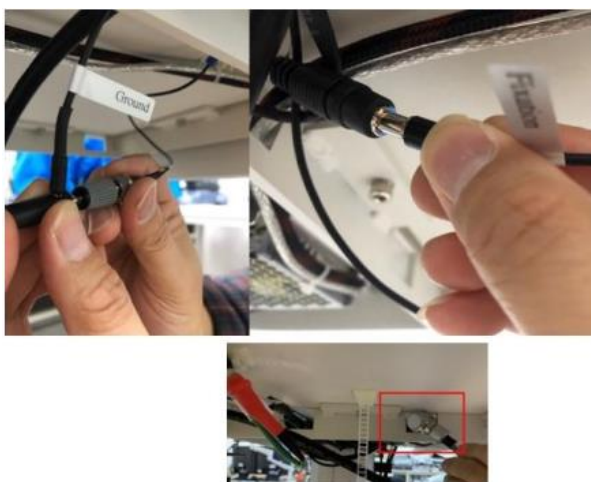
Рисунок 26: Подключение кабелей заземления щелевой лампы и лампы фиксации взгляда
