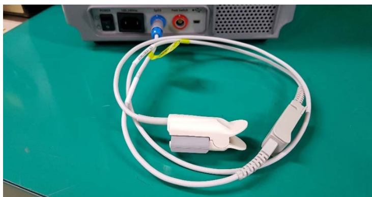
Рисунок 22. Подключение датчика SpO 2 к изделию
