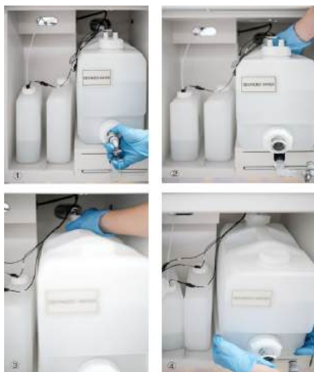
Рис. 11.4 Снятие бака для деионизированной воды
