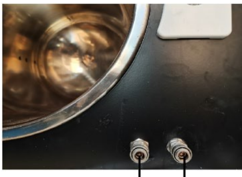
Выходное отверстие резервуара для сточных вод
