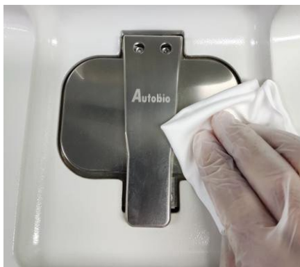
Рисунок 9.1 Очистка крышки люка
