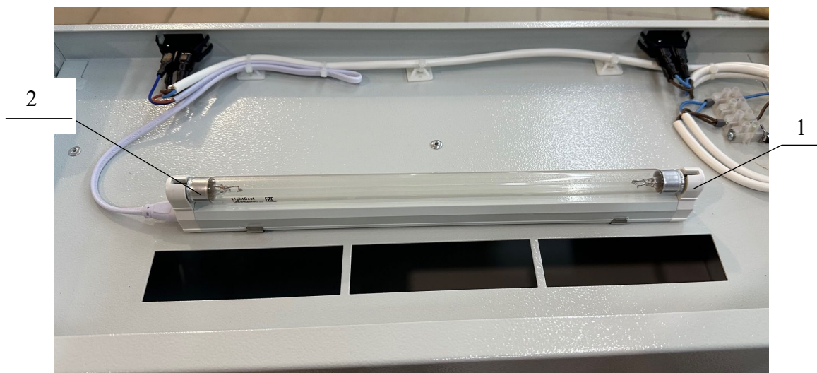
Рисунок 7 - Замена бактерицидной лампы.
