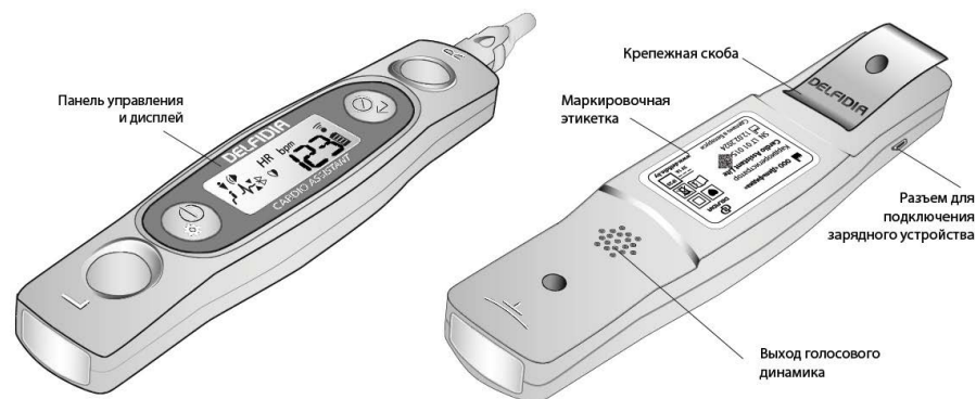
Рис.2-3. Общий вид прибора Delfidia Cardio Assistant (Home, Lite)
