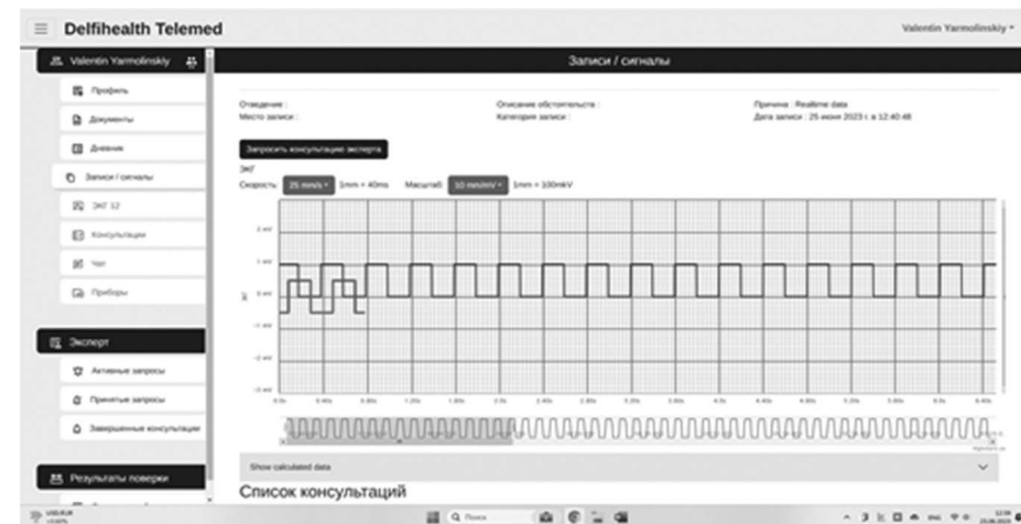
Рис.12 Калибровочный сигнал прибора, фиксируемый с помощью приложения в личном кабинете консультативного портала
