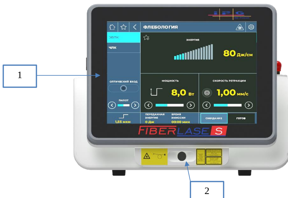
Рис. 6. Аппарат лазерный хирургический MedLase S по ТУ 32.50.50–058-18003536-2018, в исполнении FiberLase S – Вид спереди
