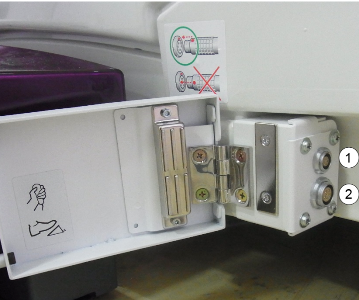
Рисунок 246 Панель доступа, расположенная на лицевой стороне гентри
