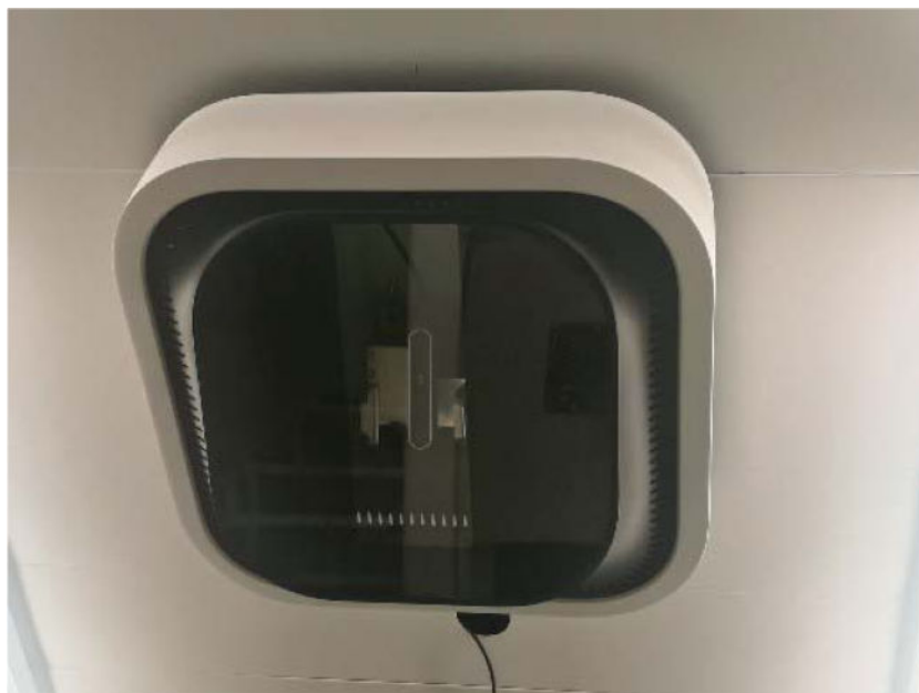
Рисунок 79 Камера глубины Xtream для автоматического позиционирования
