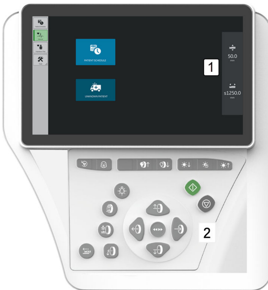
Рисунок 93 Дисплей гентри и панель управления гентри
