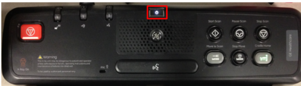
Рисунок 124 Кнопка питания на пульте управления сканированием
