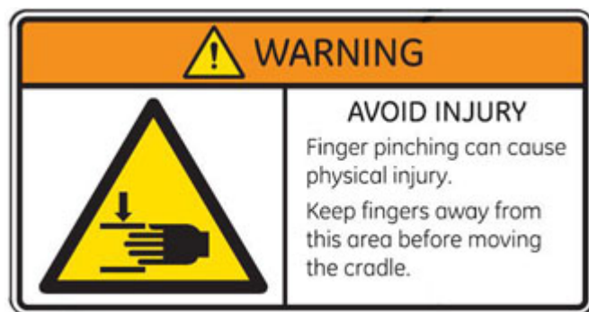
Рисунок 5 Этикетка на столе, предупреждающая об опасности защемления
