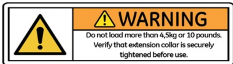
Рисунок 15 Этикетка с предостережением на ножке стойки капельницы
