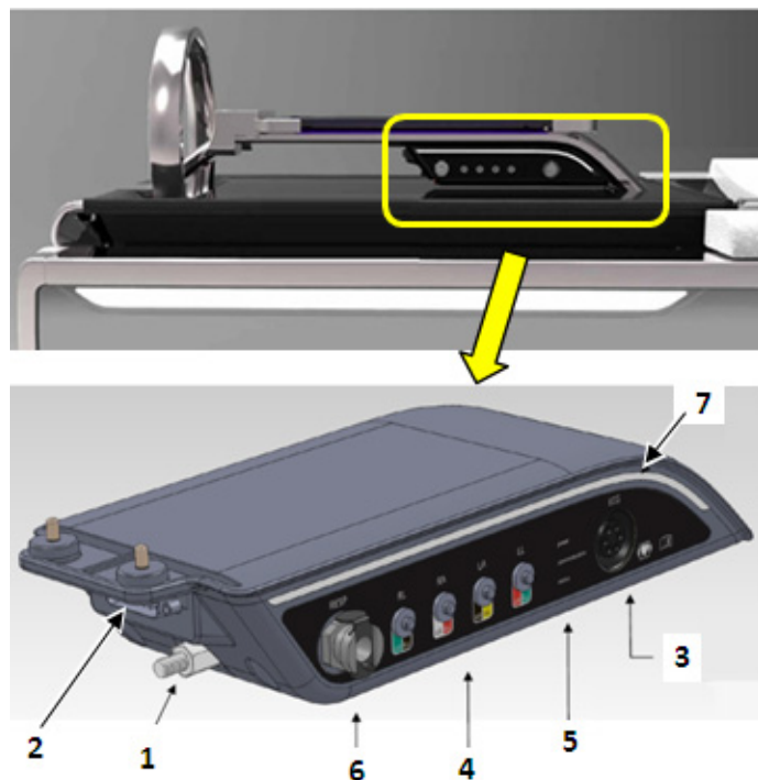
Рисунок 105 Встроенный кардиологический модуль
