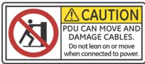
Рисунок 10 Предостережение о перемещении блока распределения питания на задней панели блока
