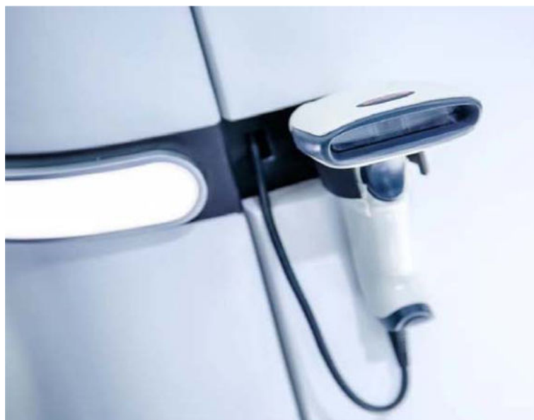
Рисунок 160 Устройство считывания штрих-кода на гентри
