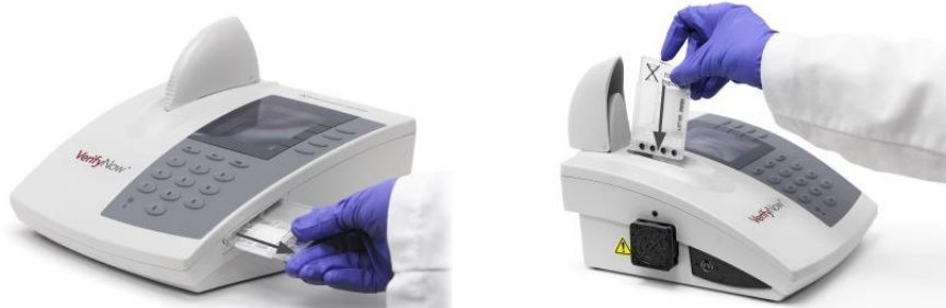
Рисунок 15: Вставка устройства EQC
