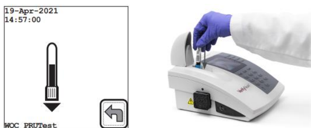
Рисунок 25: Вставка пробирки WQC
