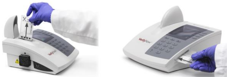
Рисунок 17: Удаление EQC устройства
