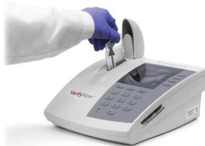
Рисунок 79: Удаление чистящего устройства
