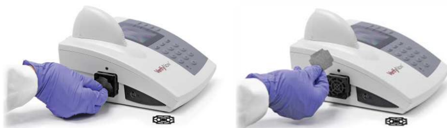
Рисунок 82: Снятие фильтра вентилятора
