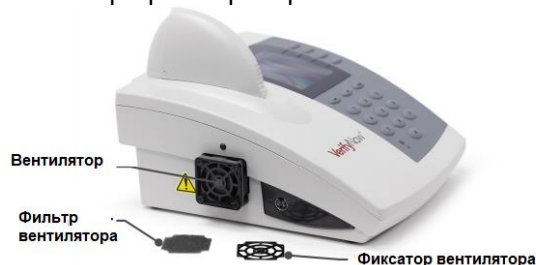
Рисунок 80: Замена фильтра вентилятора
