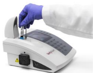
Рисунок 38: Вставка пробирки WQC
