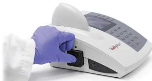
Рисунок 81: Удаление фильтра вентилятора
