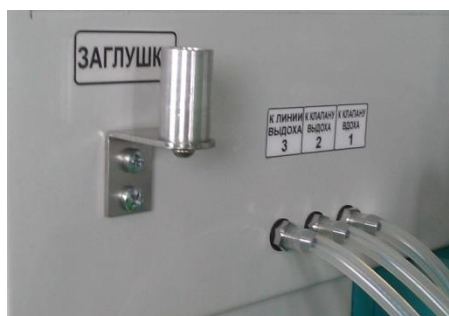
Рисунок 37 — Заглушка и штуцеры подключения трубок к дыхательному контуру
