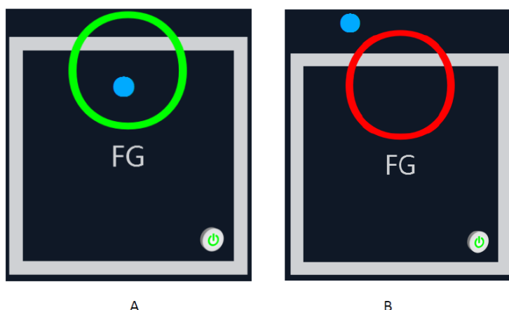
Рисунок 6-1: Настройка местоположения. На двух диаграммах показано содержимое, которое будет отображаться в окне состояния системы, когда референтная наклейка Columbus™ находится в разных положениях. (А): референтная наклейка Columbus™ находится в оптимальном положении, рекомендованном системой. (В): Референтная наклейка Columbus™ находится за пределами допустимого диапазона панели местоположения.
