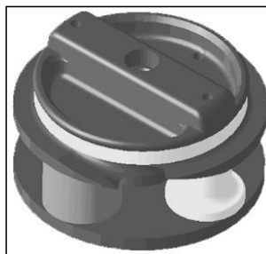
Рисунок 2-4, Ротор насоса аппарата АСР 215
