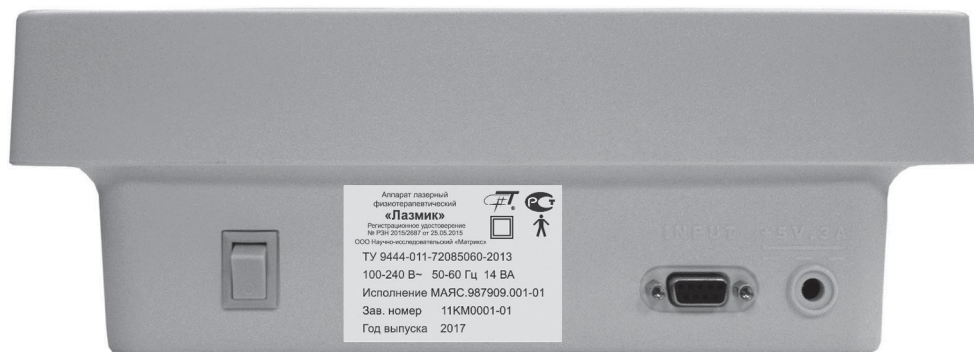
Рис. 4. Внешний вид аппарата со стороны задней панели, слева направо: сетевой выключатель, этикетка (шильдик) с указанием заводского номера аппарата и даты производства, разъём для подключения внешнего управления, разъём для подключения специального блока питания (адаптера). Маркировка ГОСТ Р МЭК 60601-1-2010:
