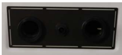
Рисунок 3.3 – Порты для присоединения воздушных шлангов
