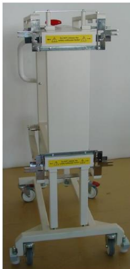
Рисунок 23. - Предохранительные замки коллиматора
