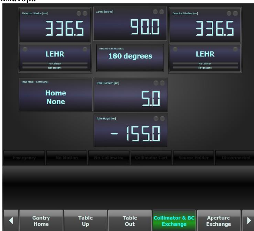
Рисунок 44. - Конфигурация детектора – Замена коллиматора
