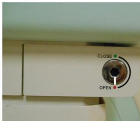
Рисунок 50. - Универсальный торцовый ключ и маркировочная черта в открытом положении
