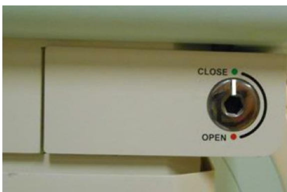
Рисунок 52. - Маркировочная черта указывает на положение CLOSE фиксатора коллиматора
