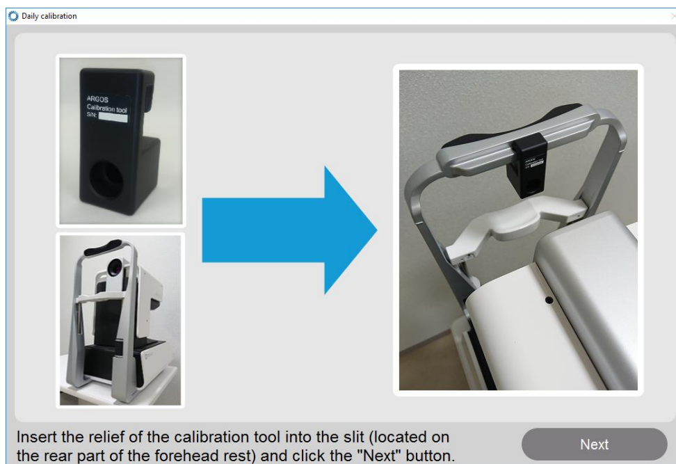
Рисунок 67 Окно с инструкциями для установки инструмента для ежедневной калибровки в правильном месте с нужной ориентацией.
