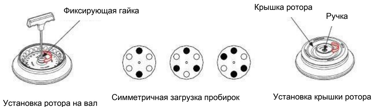
Рис. 8-4. Установка и загрузка ротора.
