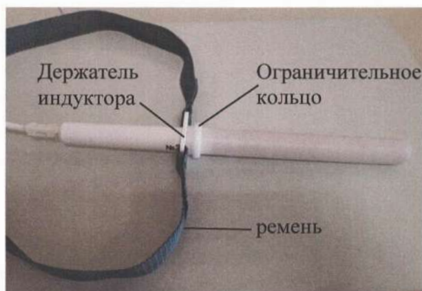
Рисунок 18. Установка ремня индуктора № 3
