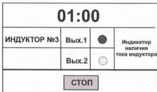
Рисунок 25 Вид экрана при подключении индуктора № 3
