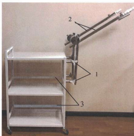
Рисунок 13 Сборка тележки (индуктородержателя)
