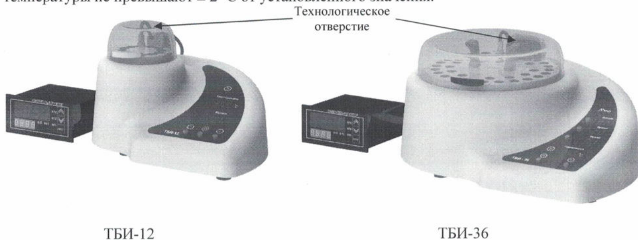
Рисунок 10 Схема для проверки отклонения температуры от заданного значения
