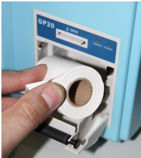
Рисунок П1-1. Замена бумаги во встроенном термопринтере.
