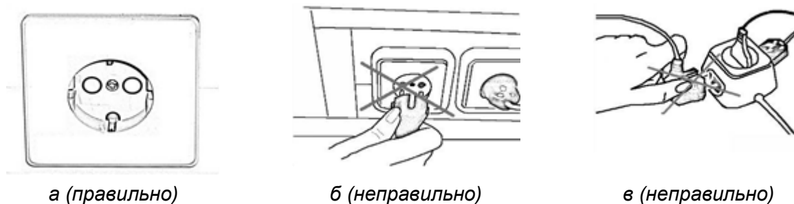
Рисунок 1-7. Подключение прибора к сети питания
