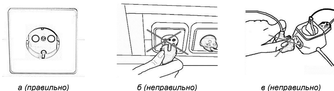
Рисунок 1-6. Подключение прибора к сети питания
