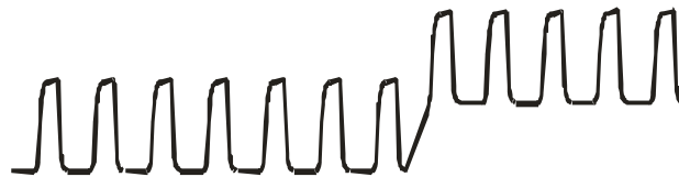
Рисунок 2-30. Скачкообразный подъем уровня капнограммы при попадании влаги на оптические элементы.
