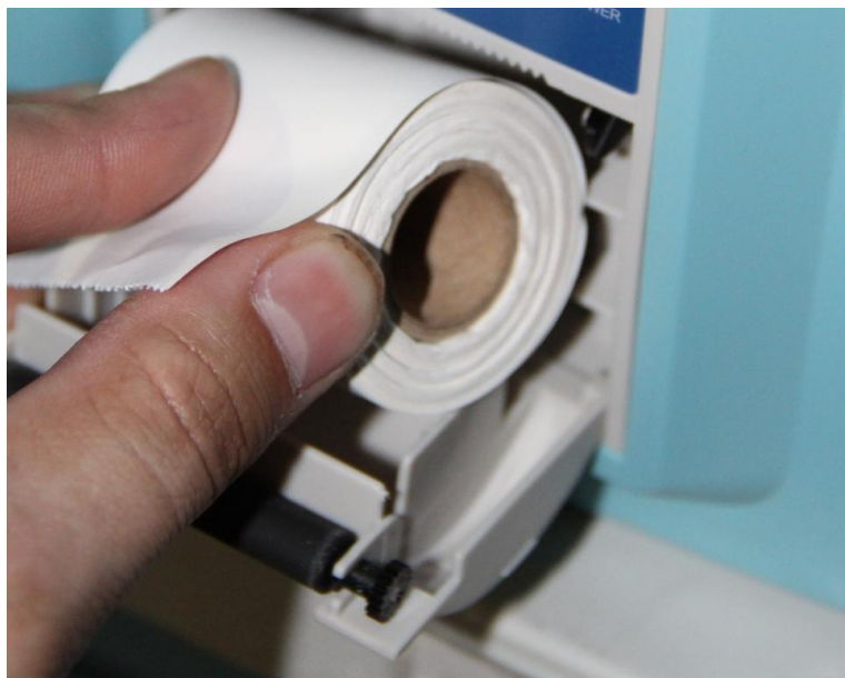
Рисунок П1-1. Замена бумаги во встроенном термопринтере
