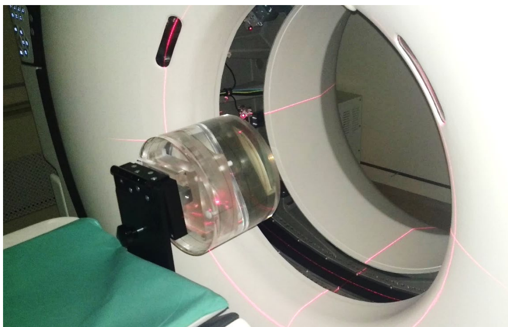
Рисунок 3.9 – Держатель фантома и системный фантом
