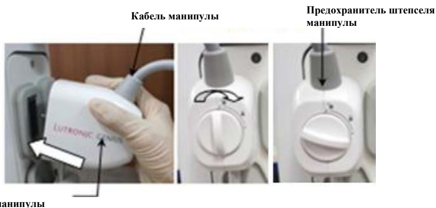
Рисунок 4.4 Соединение штепселя и разъема манипулы
