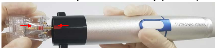
Рисунок 5.55 Сопоставление красных отметок на корпусе манипулы и наконечнике
