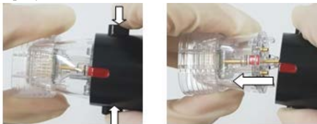
Рисунок 6.1 Отсоединение наконечника манипулы
