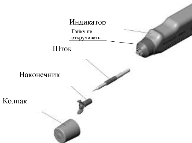
Рисунок 2 – Подготовка индикатора к очистке штокового механизма
