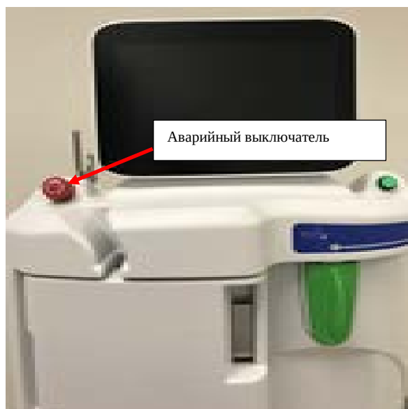
Рисунок 16. Выключатель аварийной остановки
