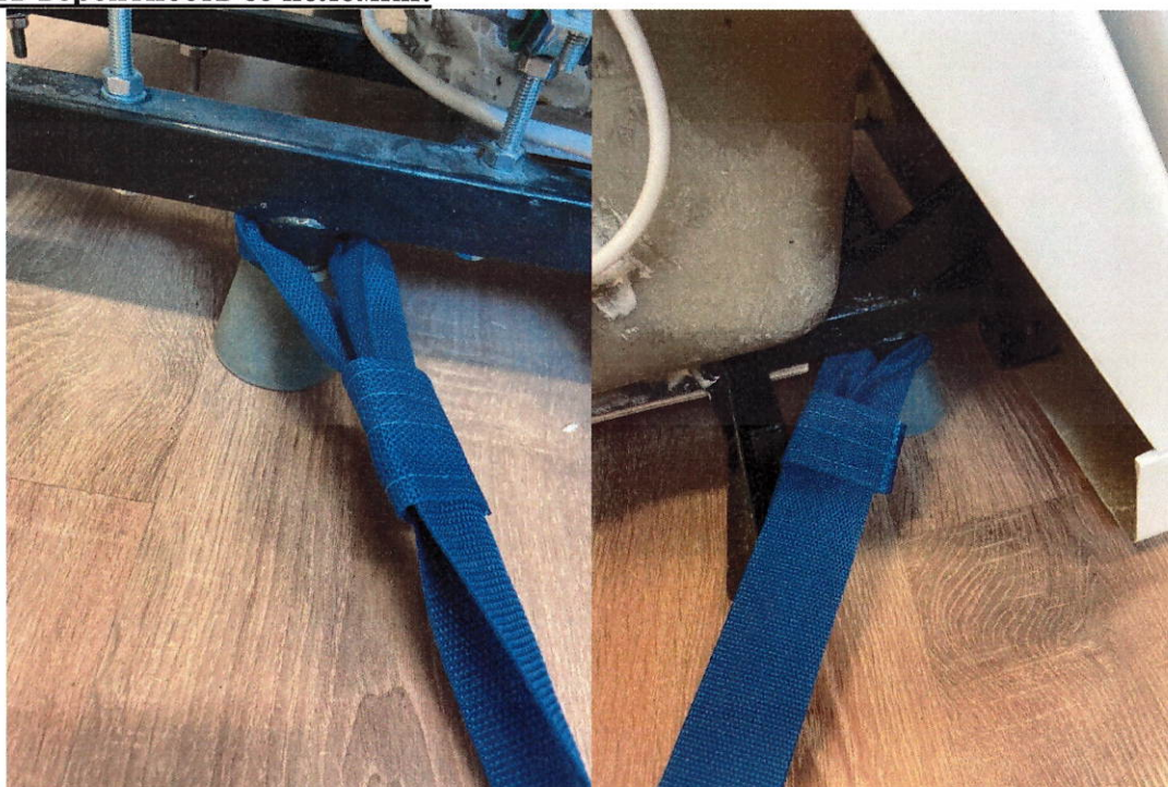
Рис.4. Транспортировочное положение троса на ножках ванны
