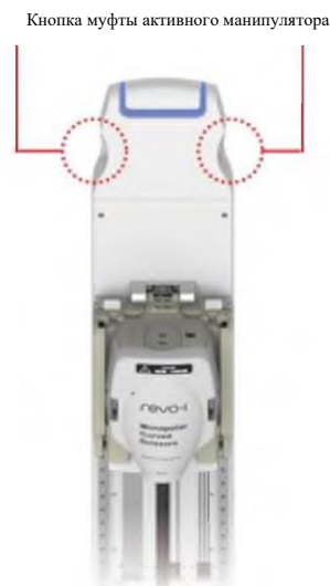
Рисунок 7-22. Регулировка положения инструмента с помощью кнопки муфты активного манипулятора
