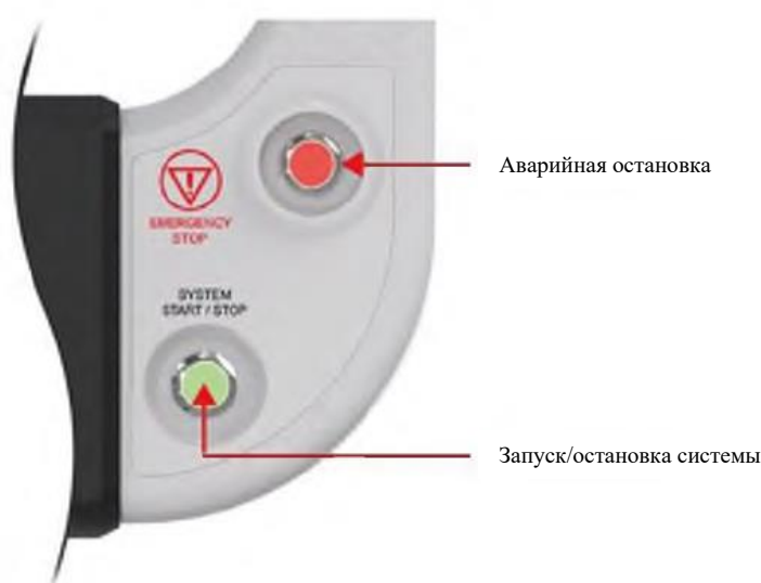
Рисунок 3-6. Кнопки запуска/остановки и аварийной остановки
