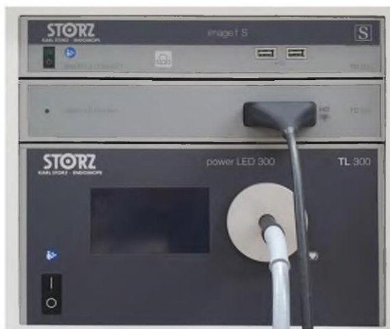
Рисунок 8-1. Состояние соединений кабеля камеры и кабеля световода
