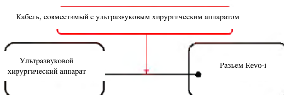
Рисунок 4-4. Схема подключения Revo-i и ультразвукового хирургического аппарата
