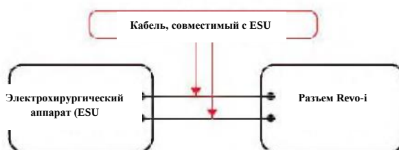
Рисунок 4-3. Схема подключения Revo-i и электрохирургического аппарата
