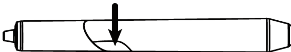
Рисунок 7 Схема установки внешнего корпуса для наконечника
