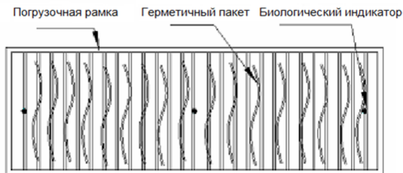
Рисунок 12 Герметичная пленка и схема расположения биологических индикаторов
