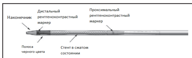
РИС. 2 Стент находится внутри катетера, на его дистальном конце, в сжатом состоянии. Черная полоса на конце катетера служит для размещения второго фланца стента при его выведении при непосредственном визуальном контроле. Два рентгеноконтрастных маркера показывают проксимальный и дистальный края стента.
