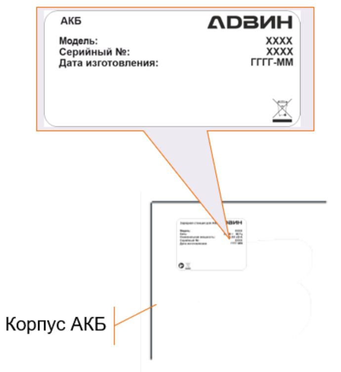
Рисунок 3.33 – Место размещения маркировки на АКБ
