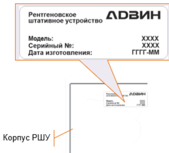
Рисунок 3.29 – Место размещения маркировки на РШУ
