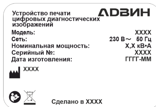
Рисунок 3.24 – Идентификационная табличка устройства печати цифровых диагностических изображений
