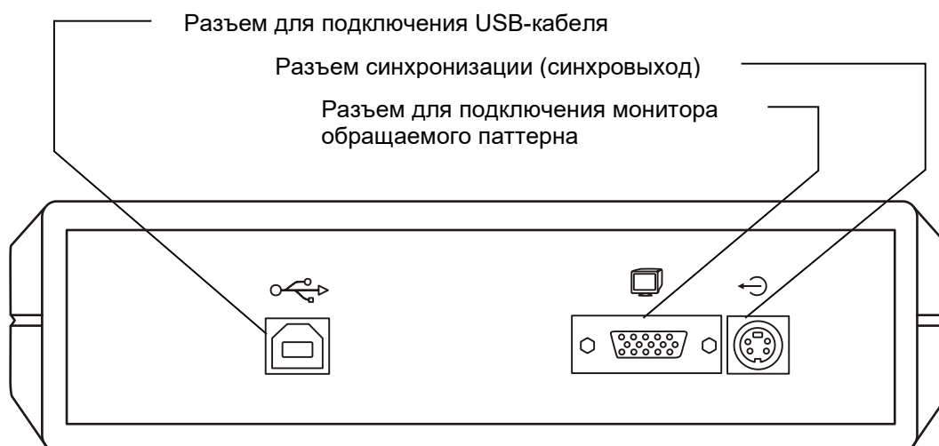
Рис. 7. Внешний вид задней панели блока аудиовидеостимулятора
