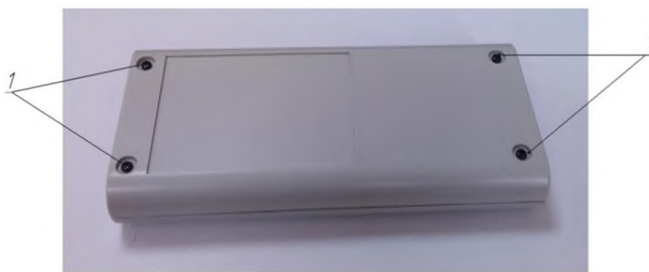
1 – Винты крепления задней панели корпуса пульта
