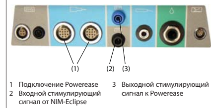
Рис. 14-2. Порты для подключения Powerease к IPC
