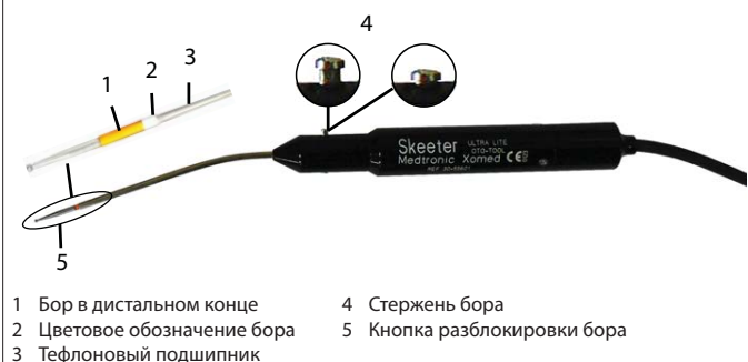
Рис. 10-1. Сборка рукоятки Skeeter
