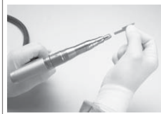
Рис. 2-2. Сборка реципрокной пилы
