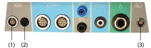
Рис. 7-5. Порты для подключения Legend EHS и Legend EHS Stylus
