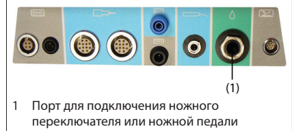
Рис. 4-5. Порт IPC для подключения Endo-Scrub 2
