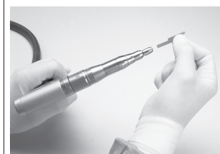
Рис. 2-2. Сборка реципрокной пилы
