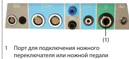
Рис. 4-5. Порт IPC для подключения Endo-Scrub 2
