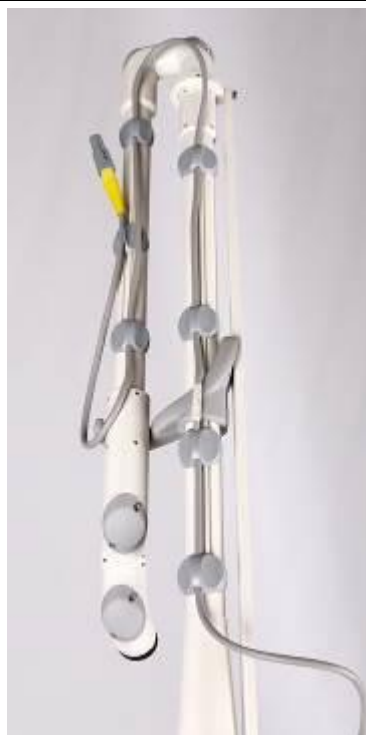
Рисунок 7: Кабель сканера, прикрепленный к шарнирному манипулятору
