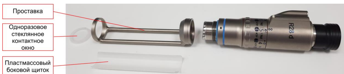
Рисунок 5.9: Разобранная проставка со стеклянным контактным окном, отсоединенная от наконечника R28 d
