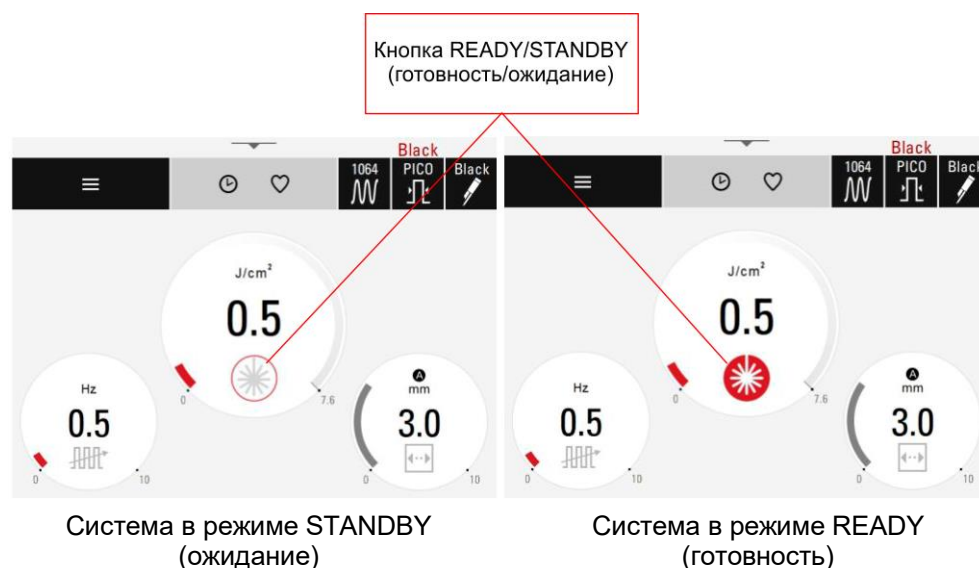
Рисунок 4.45: Кнопка READY/STANDBY (готовность/ожидание) для переключения между режимом STANDBY (ожидание) и READY (готовность)
