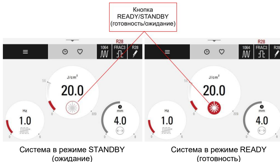
Рисунок 4.57: Кнопка READY/STANDBY (готовность/ожидание) для переключения между режимом STANDBY (ожидание) и READY (готовность)
