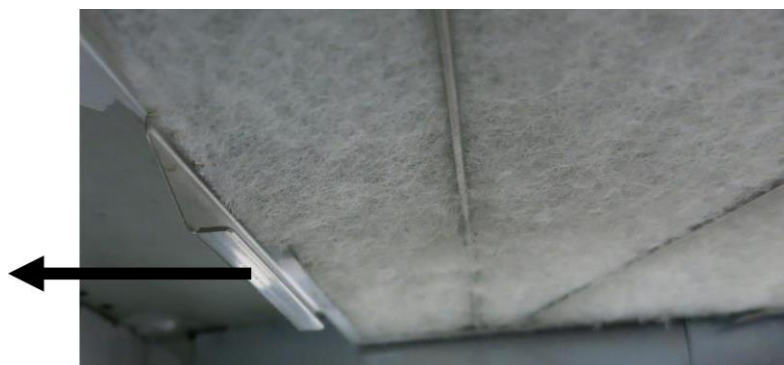
Рисунок 5.3. Рукоятка в нижней части лазерного устройства для замены воздушного фильтра
