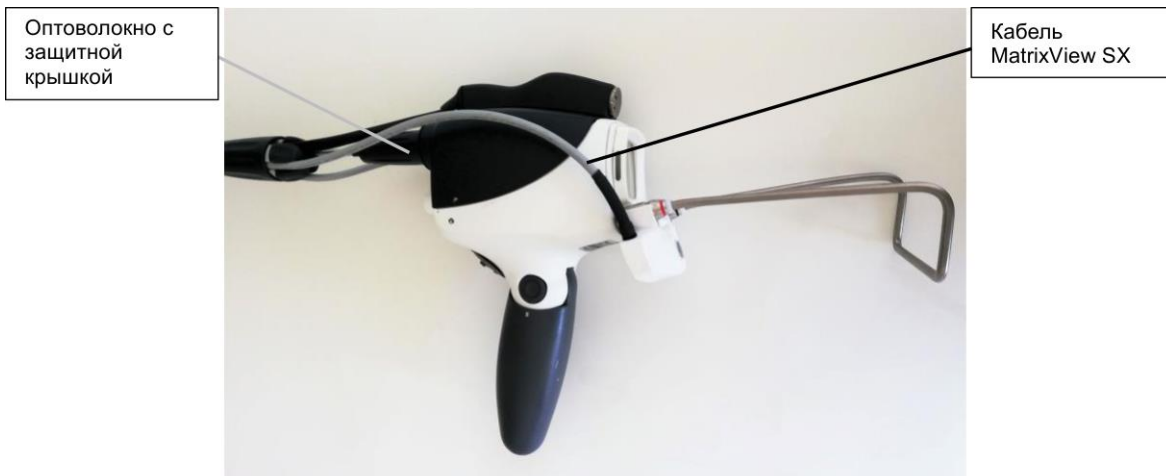
Рисунок 4.9: Сканер S11 LX Runner с соплами DMC и датчиком MatrixView SX
