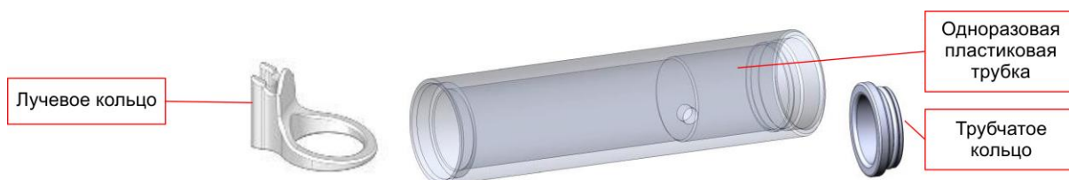
Рисунок 5.7: Проставка, отсоединенная от наконечника R585 d (это же относится к наконечнику R650 d)
