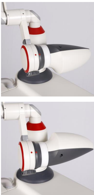
Рисунок 8: Шарнирный манипулятор и противовес в положении для сканера (вверху) и для наконечника (внизу)
