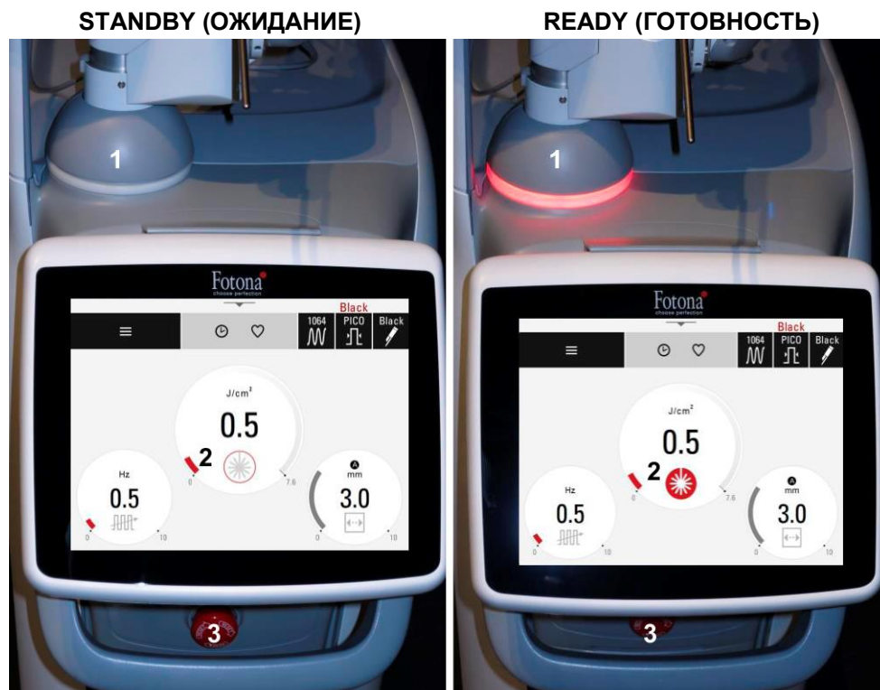
Рисунок 3.1: Слева: система в режиме STANDBY (ожидание): кнопка Ready/Standby серая, а индикатор излучения не горит. Справа: система в режиме READY (готовность): кнопка Ready/Standby красная, а индикатор излучения светится красным цветом.
