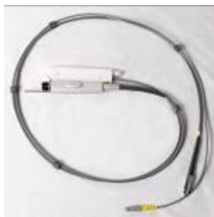
Рисунок 6: Кабель MatrixView, прикрепленный к оптоволоконному кабелю доставки
