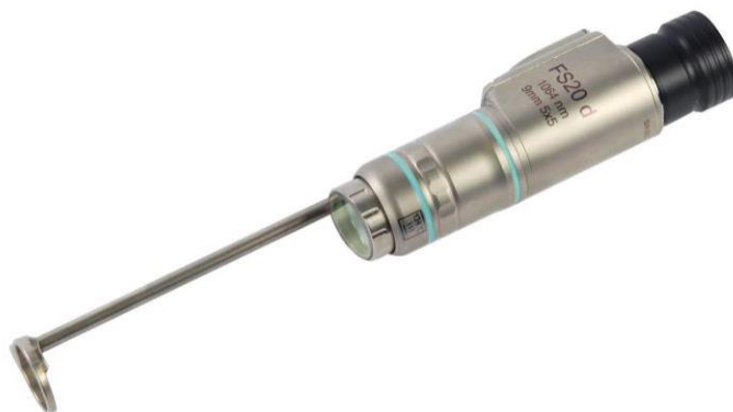
Рисунок 4.50: Наконечник FS20 d с голубым цветовым кодом (наконечники FS20A d и FS20B d выглядят одинаково)
