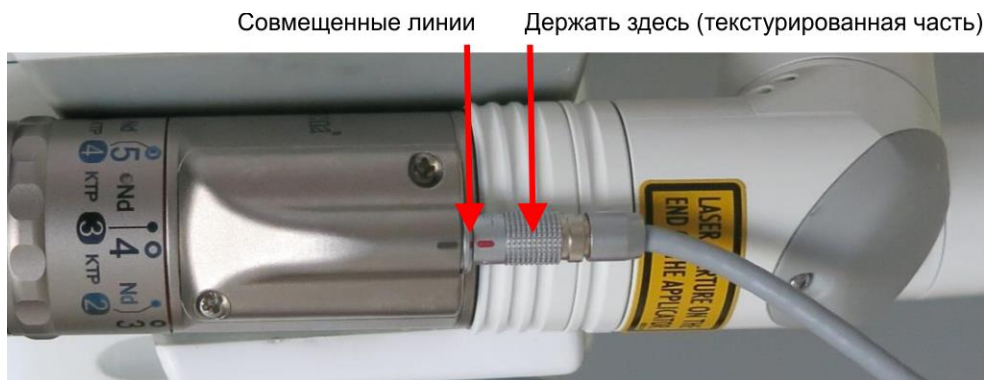
Рисунок 4.2: Подключение соединителя кабеля обнаружения
