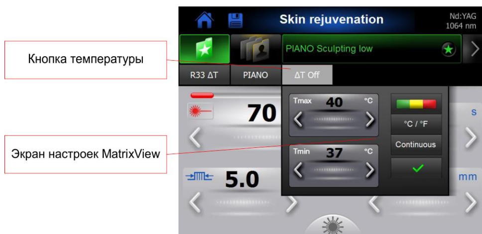
Рисунок 38: Экран приложения и всплывающее окно при использовании наконечника R33-T или R34-T с датчиком температуры кожи MatrixView
