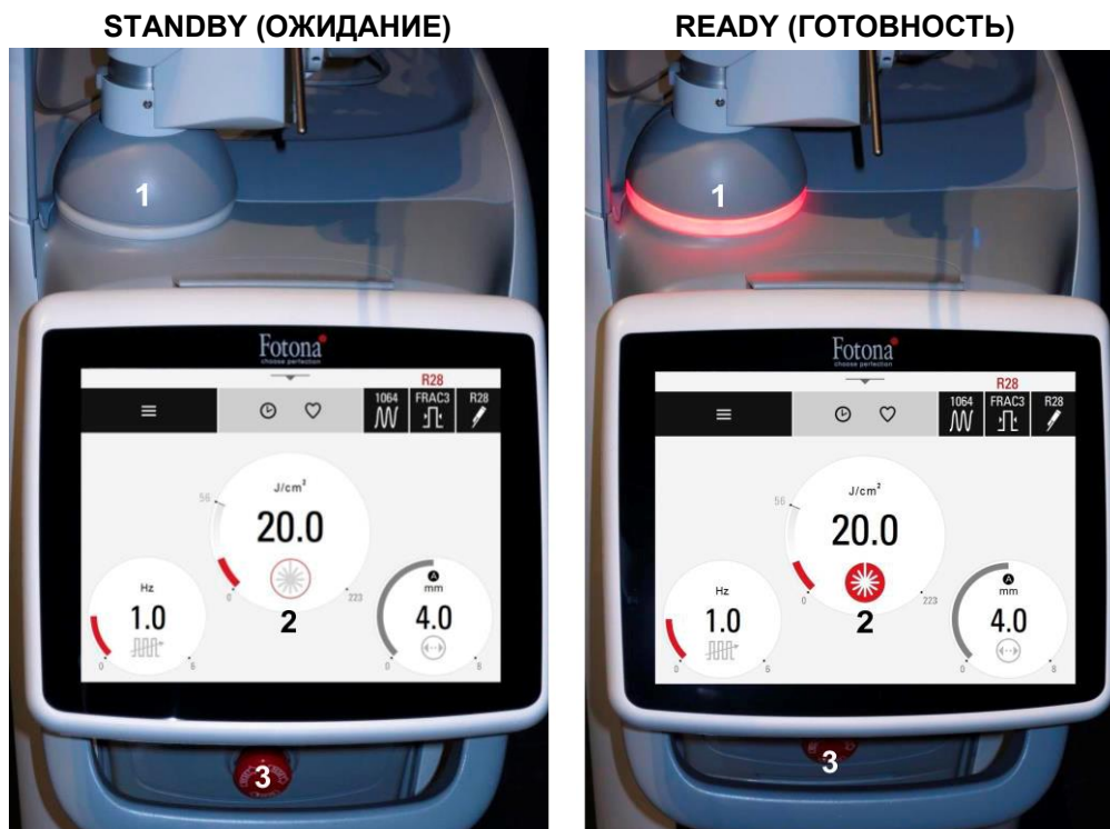
Рисунок 3.1: Слева: система в режиме STANDBY (ожидание): кнопка Ready/Standby серая, а индикатор излучения не горит. Справа: система в режиме READY (готовность): кнопка Ready/Standby красная, а индикатор излучения светится красным цветом.
