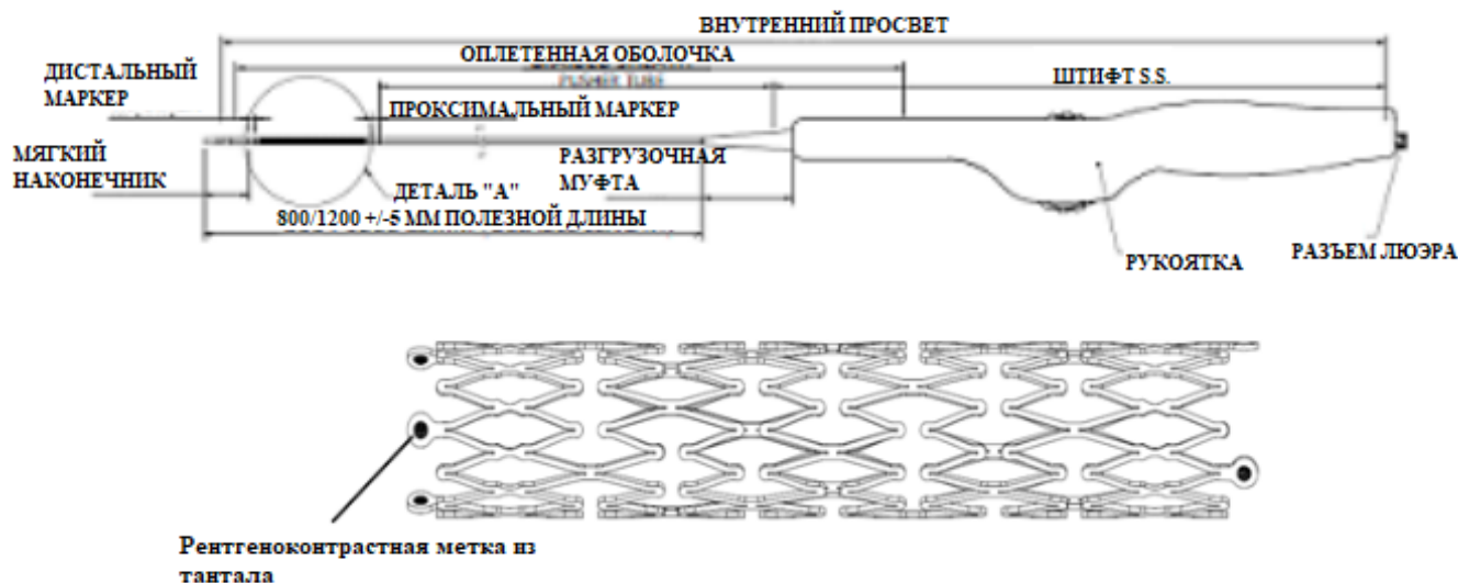
Рисунок 1. Схема системы Promesa™ BMS
