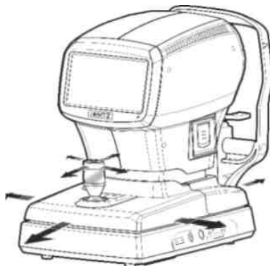
[Использование джойстика для перемещения влево/вправо и регулирования фокуса]
