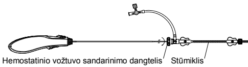
8 pav. Hemostatinio vožtuvo sandarinimo dangtelio tvirtinimo iliustracija
