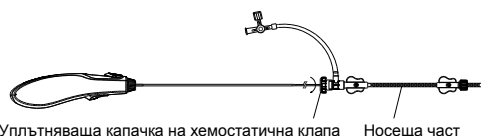
Фигура 8. Изображение на обезопасяване на уплътняващата капачка на хемостатичната клапа
