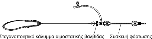
Εικόνα 8. Απεικόνιση ασφάλισης του στεγανοποιητικού καλύμματος της αισιοστατικής βαλβίδας
