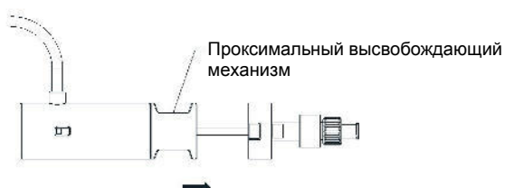
Рис. 10 Потянуть проксимальный высвобождающий механизм
