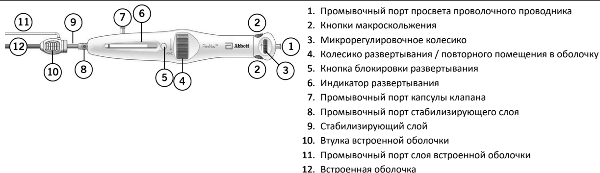
Рис. 3. Рукоятка системы доставки
